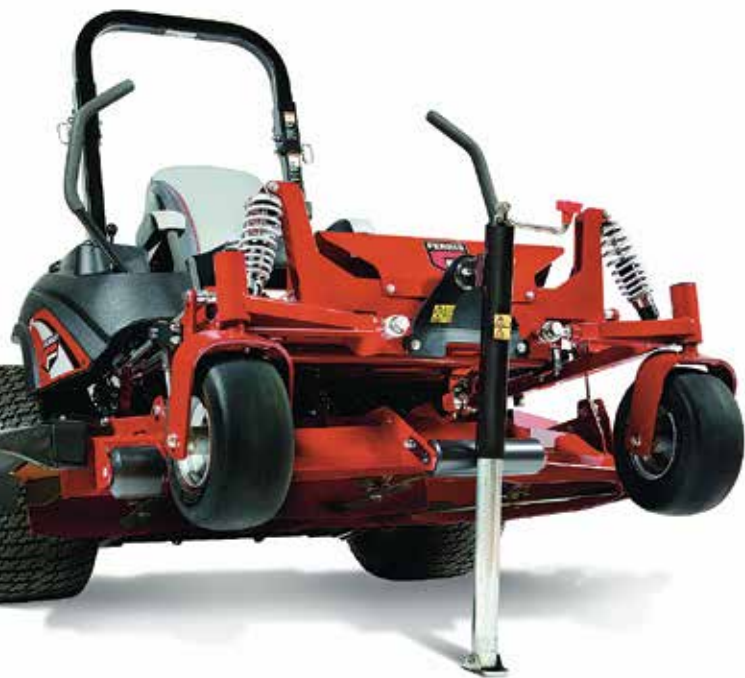
Servisna dizalica Pruža jednostavniji pristup održavanju donje strane kućišta.
